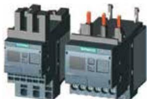
Os relés de monitoramento de corrente supervisionam não apenas os motores ou outras cargas, mas adicionam facilidades para o monitoramento da corrente ideal do sistema inteiro. A linha SIRIUS 3RR2 realiza a detecção precoce e sinaliza a redução de carga e sobrecarga.
